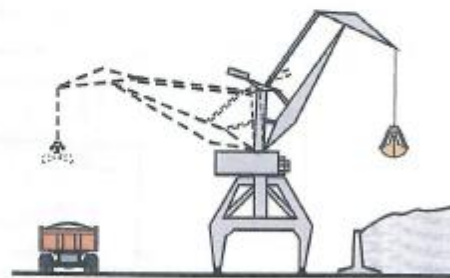
Рис.2.2-3 - Принципиальная схема перегрузки угля из склада (вариант склад - кран - автомобиль)
